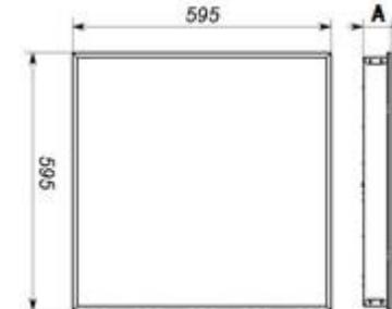
Рисунок 1.Габаритные размеры светильника.
